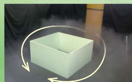
冷気が障害物を回り込む様子
