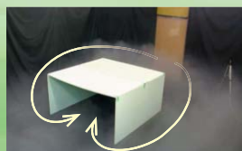
冷気が障害物を回り込む様子
